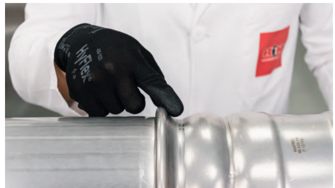
Bild 37 – Sichtkontrolle beim Verpressen von Übergrößen
