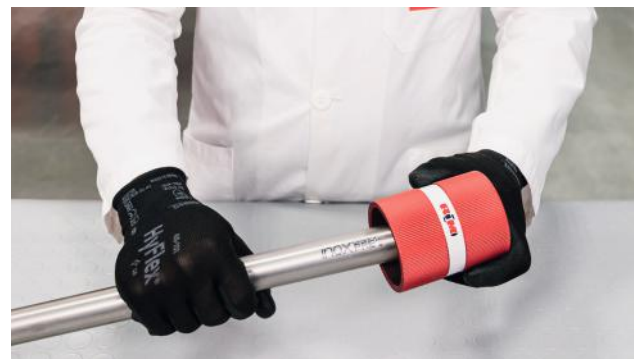
Bild 27 - Entgraten des Leitungsrohres
