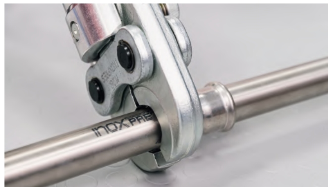
Bild 33 - Herstellen der Pressverbindung
